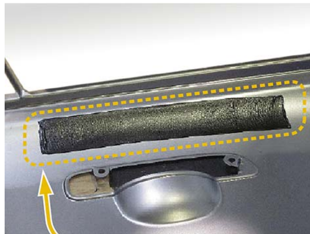
車のドア裏に塗布した鋼板補強材
